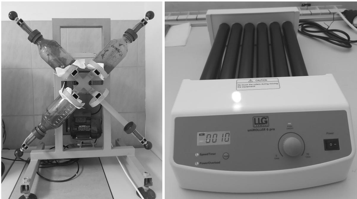
Slika 4 Uređaji za miješanje posuda s uzorcima: mehanička miješalica (lijevo) i mehanički valjci (desno)
