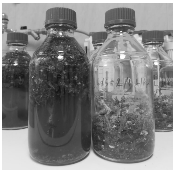
Slika 3 Posude s uzorcima pripremljenim za provjeru izluživanja
