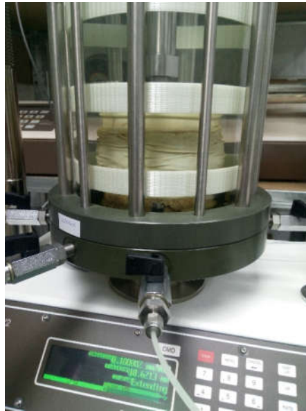
Slika 11. Treća faza triaksijalnog ispitivanja, smicanje uzorka zemlje
